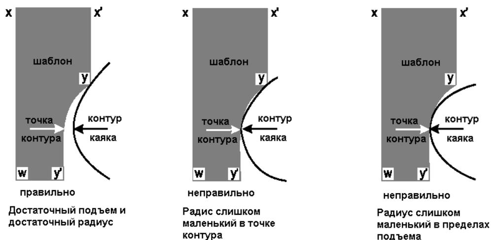
8.15.3. Для измерения радиуса кривизны соответствующая часть шаблона должен быть приложена перпендикулярно к проверяемой поверхности. Если обе точки ( $X$  и  $X'$ ) одновременно касаются поверхности каяка и в то же самое время остальная части лодки не касается шаблона, то проверка считается пройденной.
